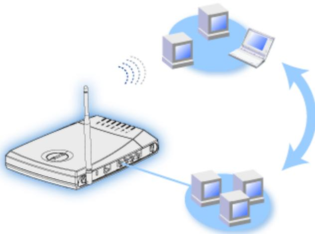
El enrutador inalámbrico de banda ancha 2300 admite hasta 252 clientes. Hasta 16 de los 252 clientes pueden ser inalámbricos. La función Traducción de Dirección de IP (NAT) permite que 64 clientes se comuniquen simultáneamente fuera de Internet. Se
